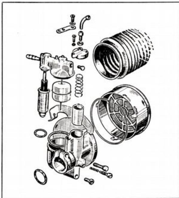
En cas d'obstruction du gicleur, nettoyer également la cuve de décanation et la canalisation du couvercle de cuve en dévissant le bouchon prévu à cet effet et en soufflant le conduit.
