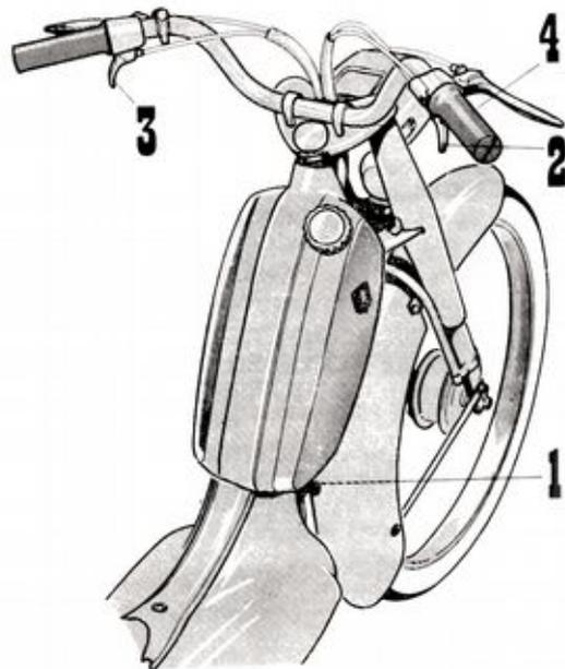
1. - Ouvrir le robinet d'essence en tirant le bouton placé à la base du réservoir côté droit (1).
