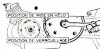
Pour rouler en pédalant sans entraîner le moteur, décrocher le levier se trouvant sur la poulie, de sa position et l'accrocher en position « mise en vélo ».
