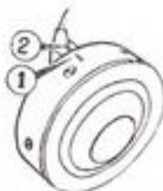
En tournant le volant dans le sens de la marche, amener en coïncidence le repère (1) du rotor avec le repère (3) du stator. S'assurer que pour cette position, les grains de contact du rupteur commencent à s'ouvrir (un papier à cigarette inséré entre les grains indiquera le commencement d'ouverture).
