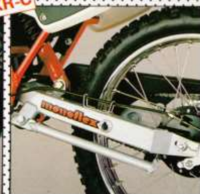
Suspension AR Monoflex Exclusivité PEUGEOT
