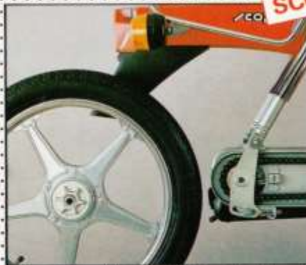
Démontage de la roue AR sans toucher à la chaîne.
