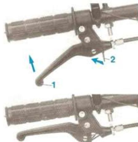
**Nota :** Pour déplacer le véhicule moteur à l'arrêt, il suffit d'actionner le levier de mise en vélo. Le verrouillage n'est pas nécessaire.
