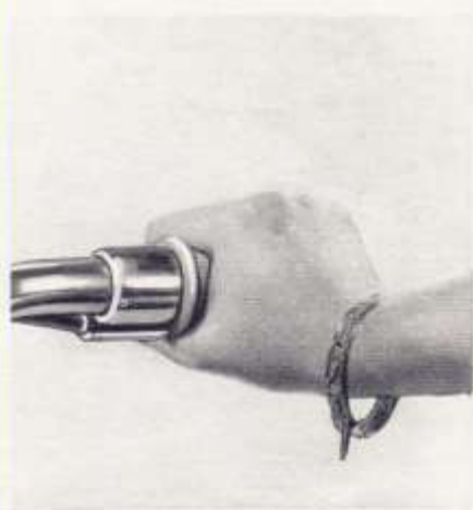
Commande des gaz du décompresseur par poignée tournante.
