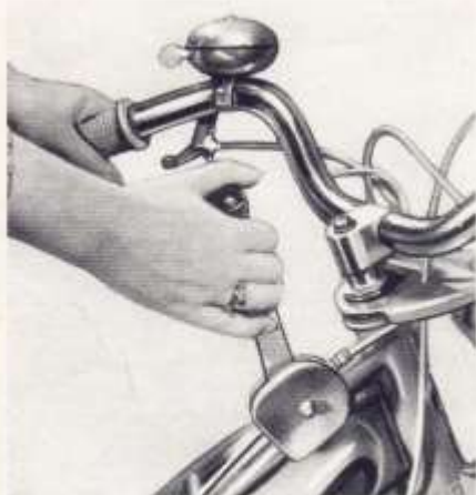
Commande de l'embrayage et du décompresseur synchronisés.
