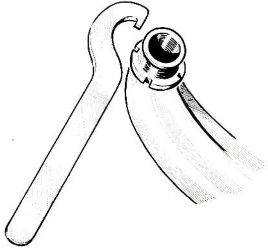
0.74 - Clé pour écrou de pot d'échappement.
