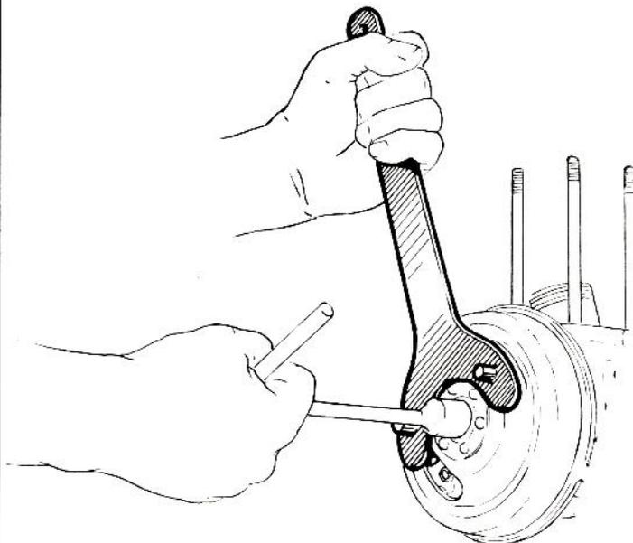
0.21 - Griffe de maintien pour le démontage du volant magnétique.
